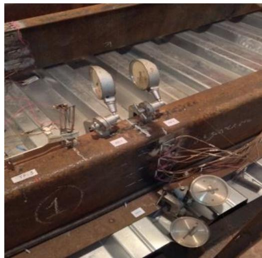
а) опорные конструкции и пневматическая система нагружения при испытаниях;
